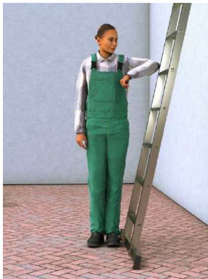
Fig. 59 „Méthode du coude“ pour déterminer l'angle d'application
