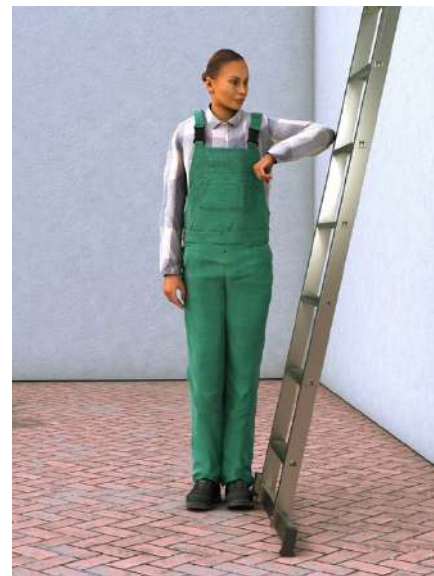
Fig. 59 „Metodo del gomito“ per determinare l'angolo di applicazione
