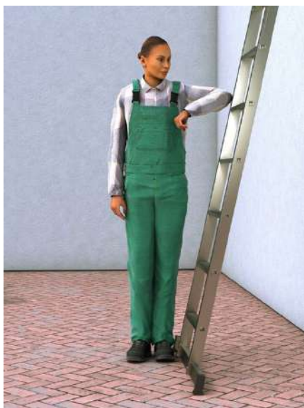
Abb. 59 „Ellbogenmethode“ zur Bestimmung des Anlegewinkels
